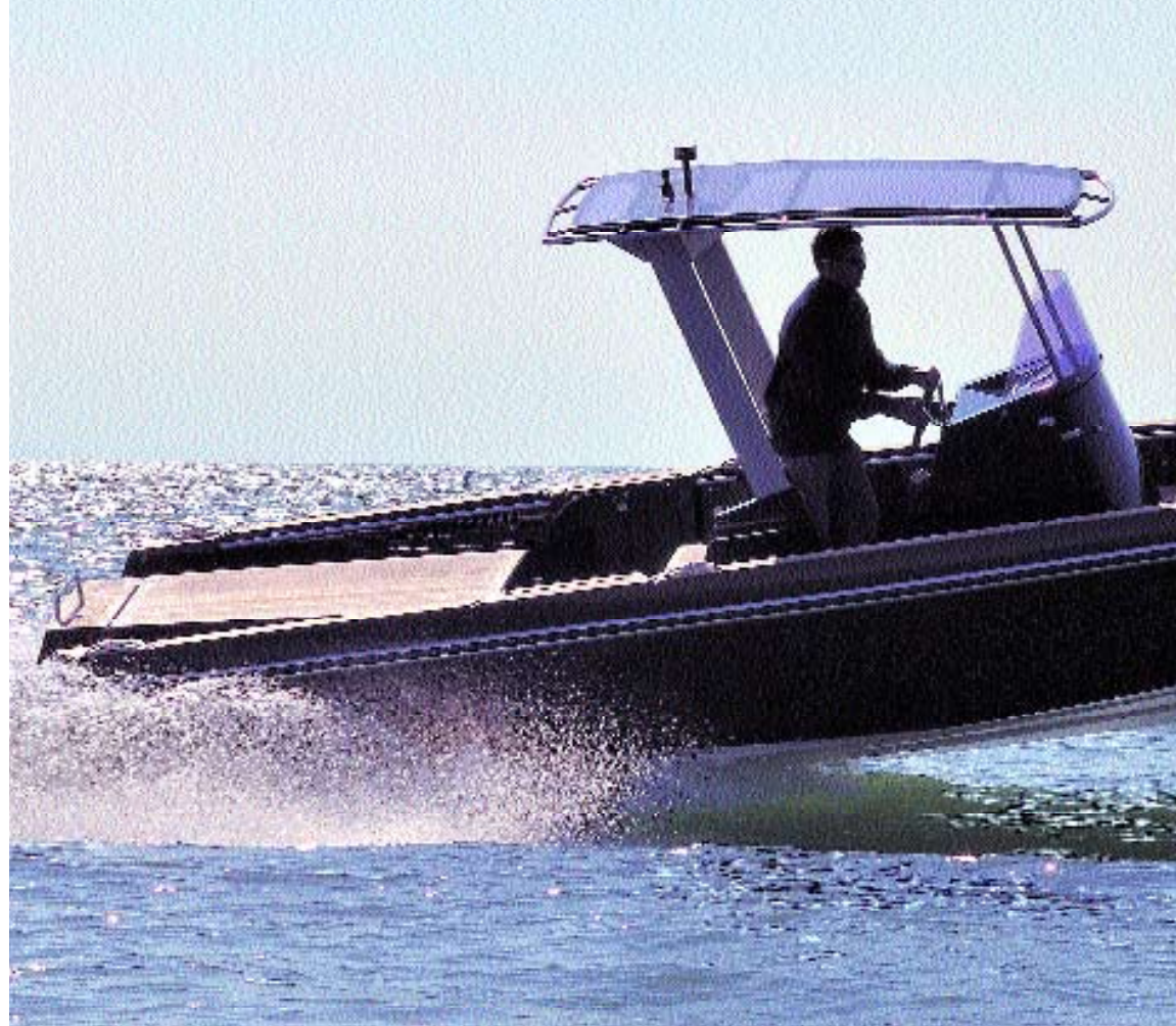
Tiefes V vorne, flaches V hinten, dazu wenig Gewicht, das sind beste Voraussetzungen für schnelles Gleiten. Gewöhnungs
